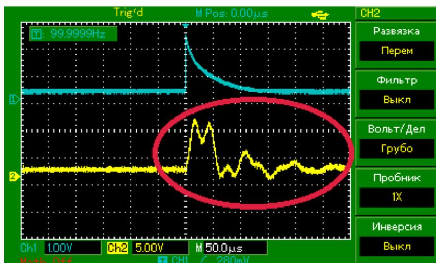
Рисунок 2 – Осциллограммы входного (1 канал) и выходного (2 канал) сигналов снятых с обмоток одной фазы двухобмоточного силового трансформатора
