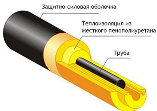
Рисунок 2 – Схема тепловой изоляции из пенополиуретана
