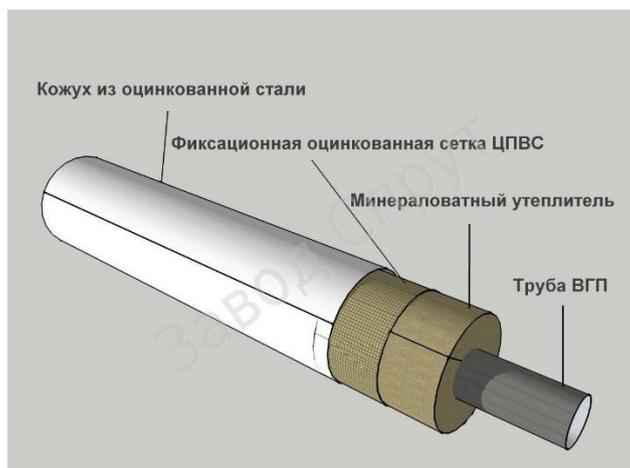
Рисунок 1 – Схема тепловой изоляции из минеральной ваты
