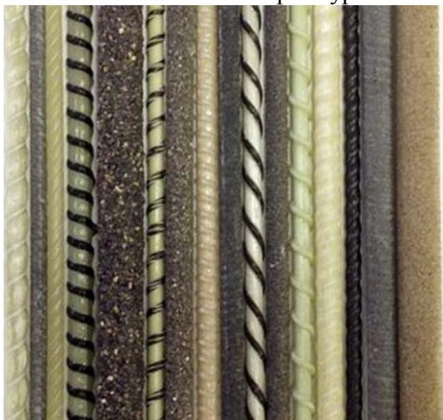
Рисунок 2 – Композитная арматура
