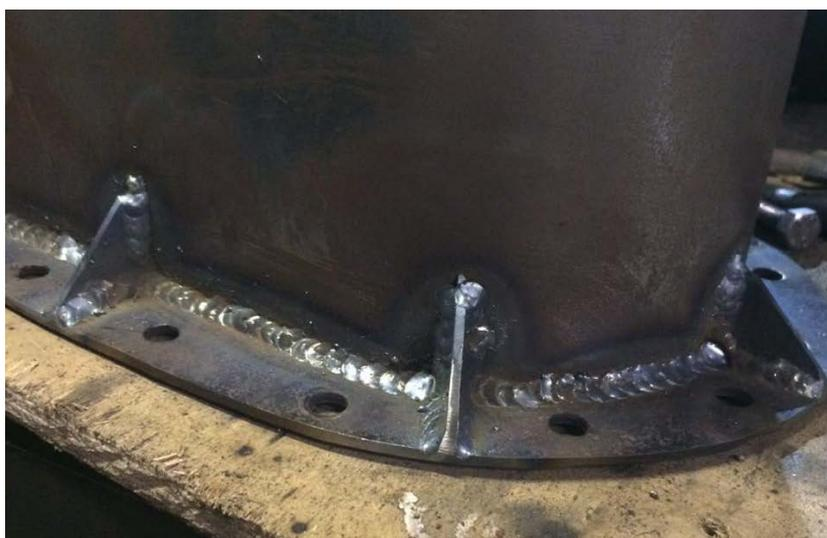
Рис. 6. Выполнение сварного соединения фланца
