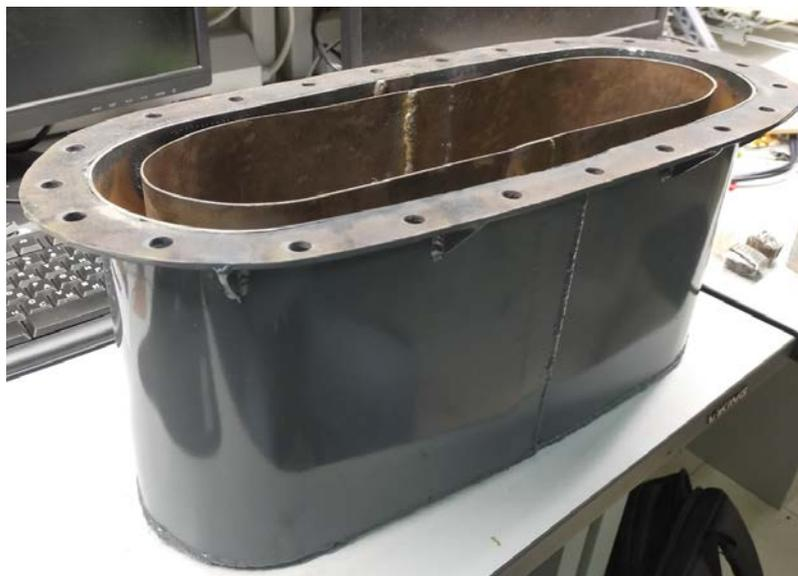
Рис.5. Вид криостата (бака) сверху без крышки.
