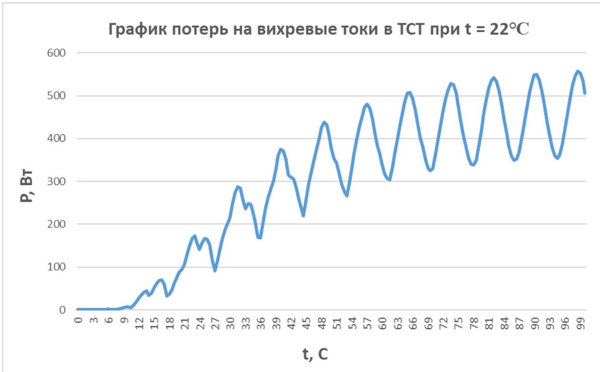
Рисунок 4 - Потери на вихревые токи в ТСТ
