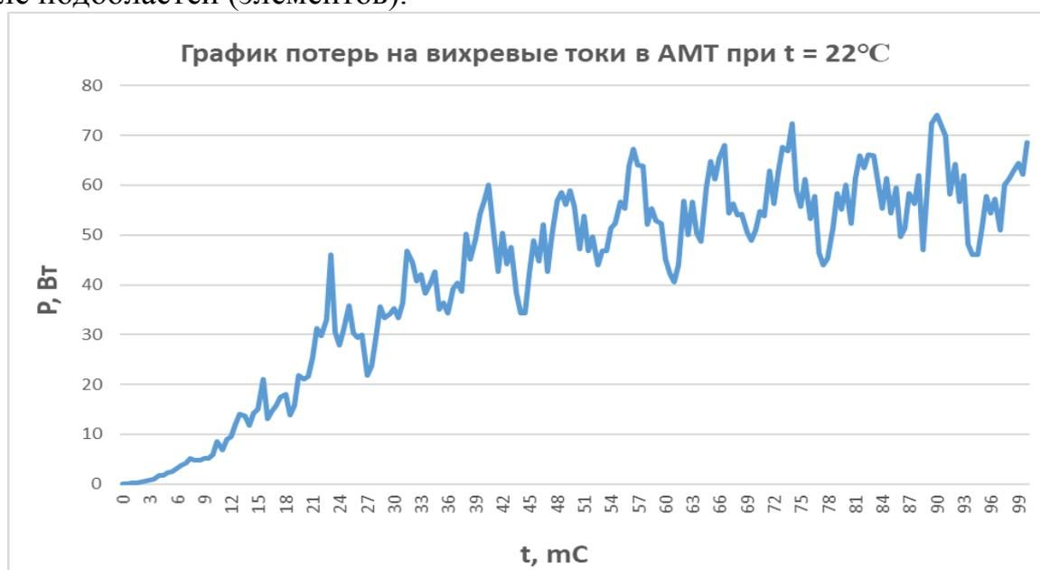
Рисунок 3 - Потери на вихревые токи в АМТ
