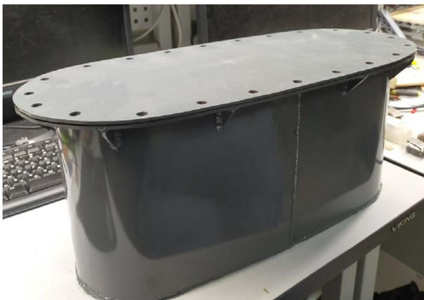
Рис.4. Сварной овально-цилиндрический криостат трансформатора.
