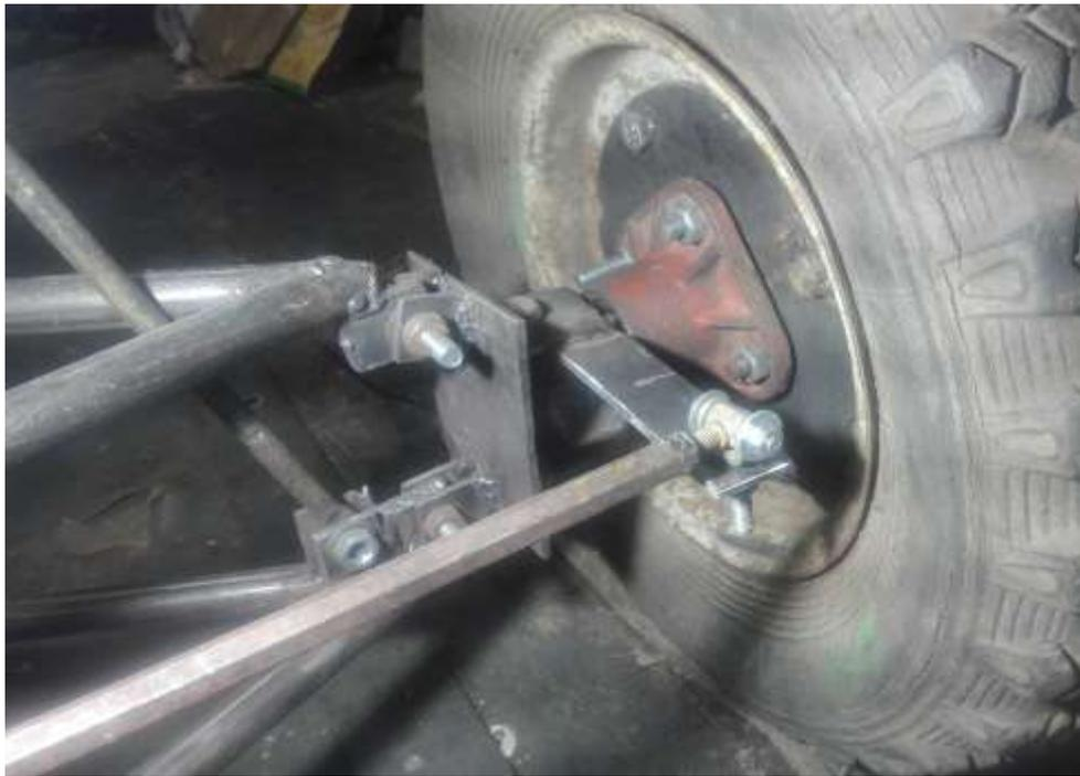
**Рисунок 4 – Устройство поворотного кулака**
