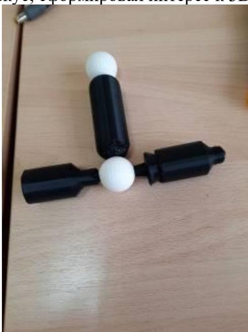
Рисунок 11 – Детали МКС напечатанные на 3D принтере
